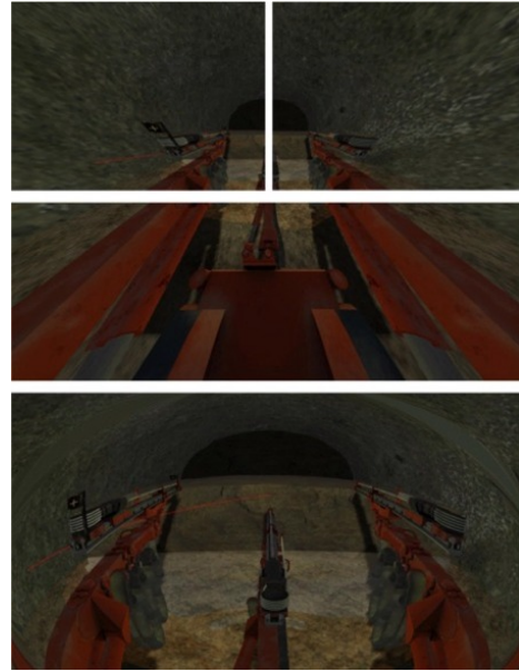
Figura 4: Imágenes generadas mediante proyección perspectiva y la imagen final que se genera mediante proyección esférica
